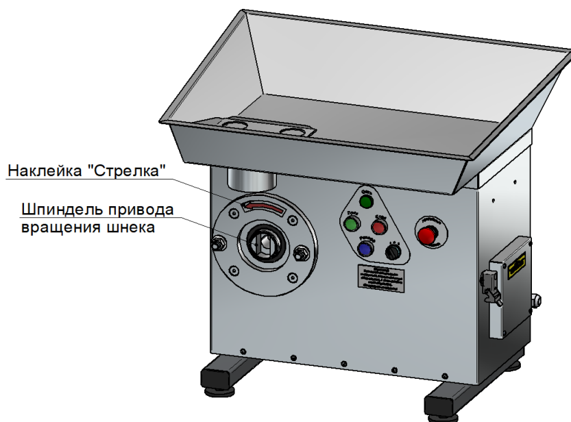
Рис. 3 Контроль направления вращения привода шнека
