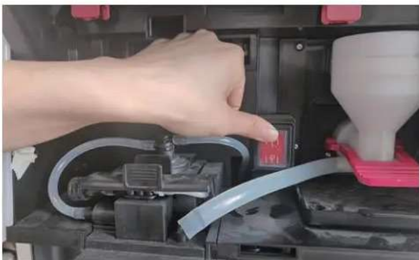
1. Поднимите переднюю операционную (дисплейную) панель и включите питание
